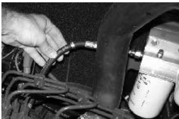
Резиновые топливопроводы подвергаются износу независимо от интенсивности эксплуатации машины. Заменяйте топливопроводы и ленточные зажимы каждые два года.
