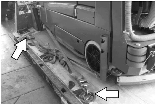
10. Если погрузочная поверхность не горизонтальна или расположена выше 380 мм от земли, для разгрузки машины используйте лебедку.
