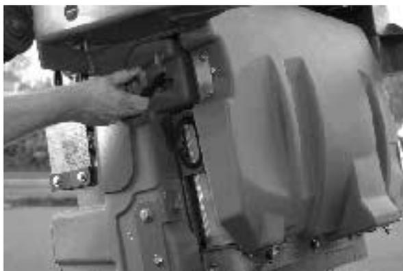
5. Откройте крышку фильтра и прислоните ее к машине.
