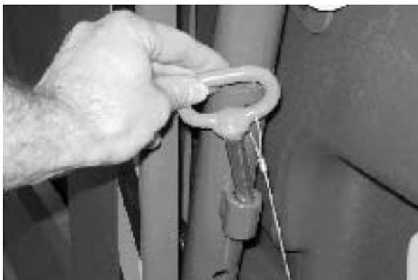
5. Вставьте опорную штангу бункера в одно из трех опорных отверстий. Опустите бункер так, чтобы он опирался на опорную штангу.
