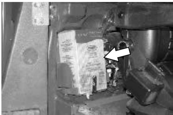
4. Удалите с новой картонной упаковки FaST-ПАК перфорированную выбивку. НЕ вынимайте мешок из коробки. Вытяните разъем шланга, расположенный на нижней части мешка, и снимите с разъема колпачок.
