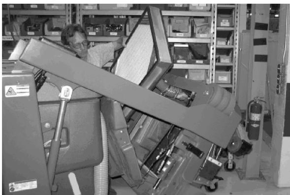
7. Очистите или утилизируйте пылеулавливающий фильтр. См. раздел **ОЧИСТКА ПЫЛЕУЛАВЛИВАЮЩЕГО ФИЛЬТРА БУНКЕРА** данного руководства.
