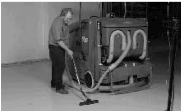
9. Закончив уборку, нажмите *кнопку вытяжного вентилятора чистки/швабры*, чтобы отключить отсос. Лампочка над этой кнопкой погаснет.
