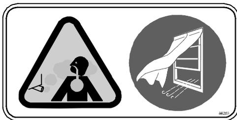
**ЗНАК СИГНАЛИЗАЦИИ ОБ ОГНЕОПАСНЫХ ПРОЛИТЫХ ЖИДКОСТЯХ** - Располагается на стенке отсека оператора.
