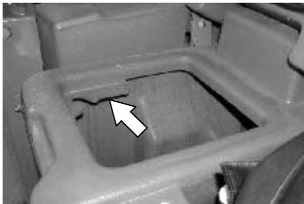
2. Откройте крышку бака утилизации и наполните бак утилизации водой (температурой не более 60°C) приблизительно наполовину.
