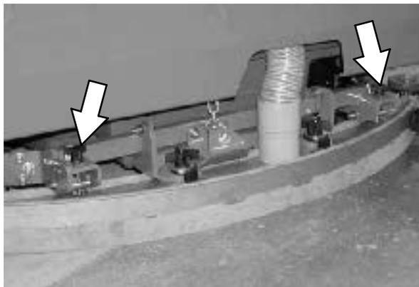
4. Опять проведите машину вперед, чтобы вновь проверить отклонение лезвия швабры после проведенных регулировок.
