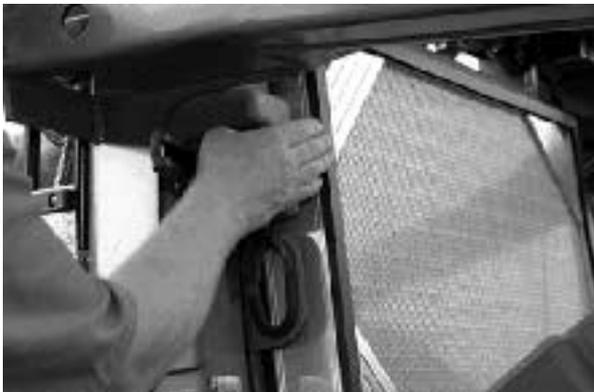
9. Закройте крышку фильтра и прикрепите крышку фильтра к бункеру ручками.
