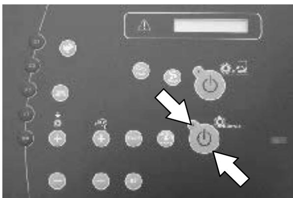
*ПРИМЕЧАНИЕ: НЕ включайте систему FaST во время обычной чистки. Обычные моющие средства могут вызывать отказы системы FaST. Перед задействованием системы FaST слейте бак раствора, промойте и повторно заполните чистой прохладной водой.*
