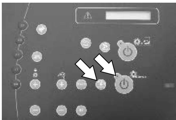
7. Нажмите кнопку вытяжного вентилятора чистки / швабры. Лампочка над кнопкой загорится, и вытяжной вентилятор начнет работать.
