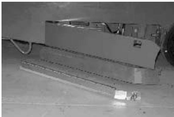
5. Снимите лезвие боковой швабры. Если внешняя кромка лезвия швабры износилась, поверните лезвие швабры, поставив на ее место кромку с другой стороны машины. Если износились обе стороны, выбросьте лезвие швабры.
