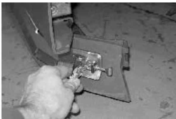
4. Снимите стяжной хомут с узла боковой швабры.
