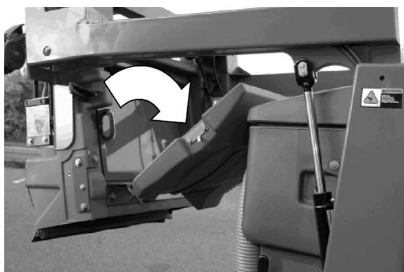
6. Снимите пылеулавливающий фильтр с бункера.
